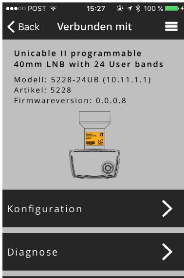
Abbildung 41: Unicable II™ verbundenes Gerät, LNB
